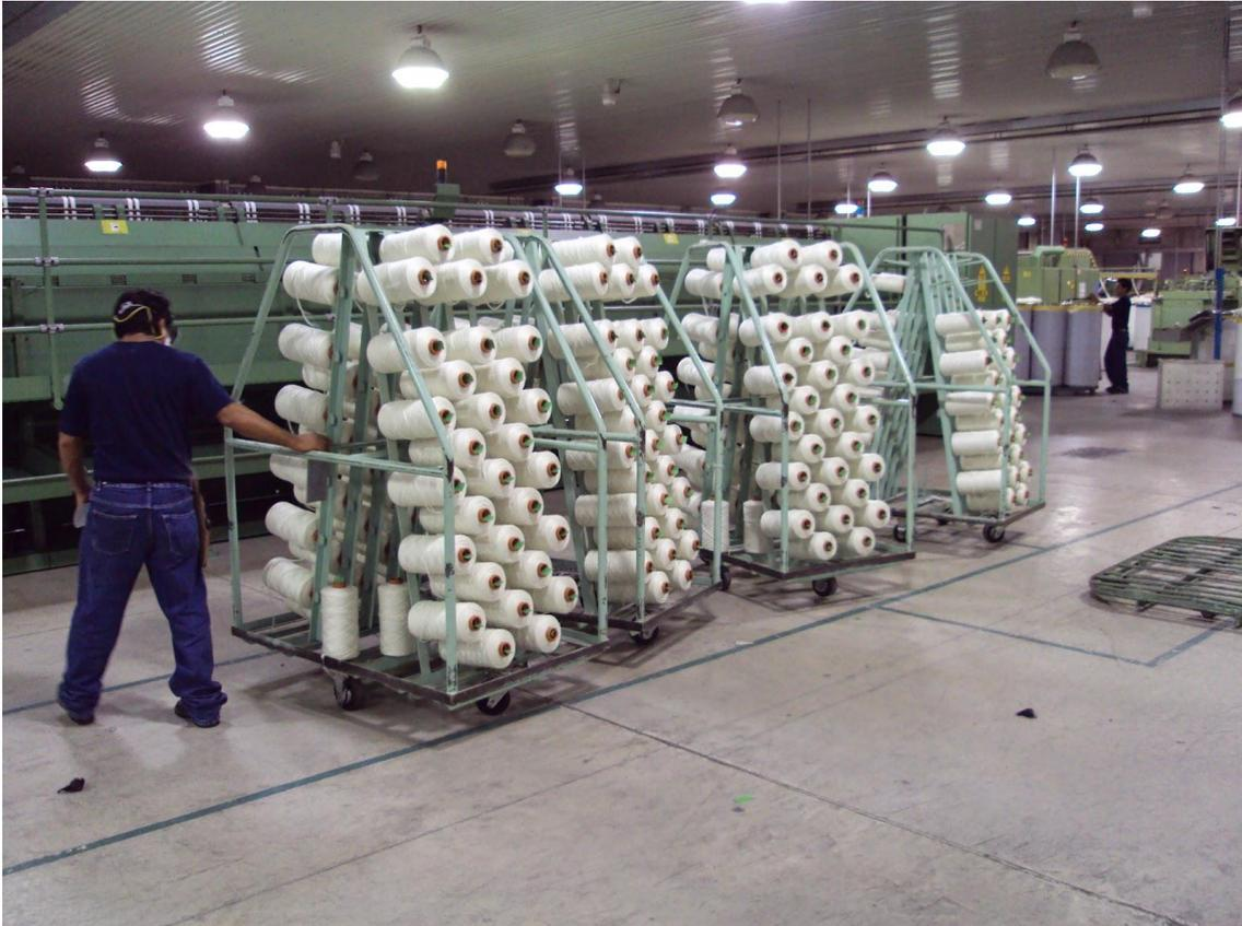
Los coches Transportadores de conos de hilos son muy necesarios dentro de una planta textil, pues ahorran esfuerzo y tiempo haciendo que la tarea sea más sencilla y segura. Son construidas con las especificaciones exactas del cliente de esta manera se fabrica para diversas capacidades, forma y tamaño del cono, esto permite que se optimice los espacios
